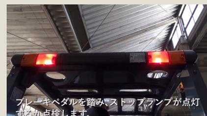
ブレーキペダルを踏み、ストップランプが点灯するか点検します。
